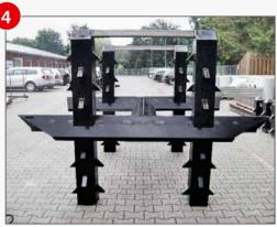
Der Diffusor befindet sich am Boden des Behälters oder Silos – in der Nähe des Materialaustritts. Ein Zwei-Ebenen-Diffusor wird für Sand verwendet.
