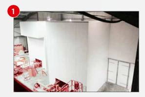
Die Härtekammer wird mit gedämmten Sandwichpaneelen verkleidet. Energieverluste werden dadurch erheblich reduziert. Mit einer von KRAFT gelieferten Konstruktionszeichnung und Stückliste können Sie die Kammer auch selbst isolieren.
