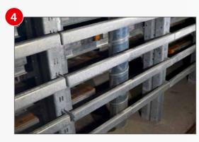
Unser im Hause KRAFT entwickeltes Luftverteilungssystem - mit Luftauslässen ausschließlich am Kammerboden - garantiert ein höchst gleichmäßiges Kammerklima. Dabei bleibt der Kammerboden dauerhaft trocken und Luftzug auf dem frischen Beton wird vermieden.
