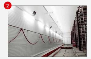
Dank unserer Technik können selbst bei 40°C und 90 % r. F. Nebel und Kondensat in der Klimakammer verhindert werden. Dadurch ist ein störungsfreier Betrieb der Sensoren (Licht- oder Lasersensoren) gewährleistet. Die Stahlkonstruktion bleibt korrosionsbeständig.
