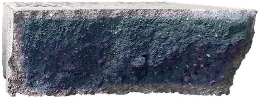
Deutlich erhöhte Karbonatisierungstiefe durch höhere CO<sub>2</sub>-Mengen
